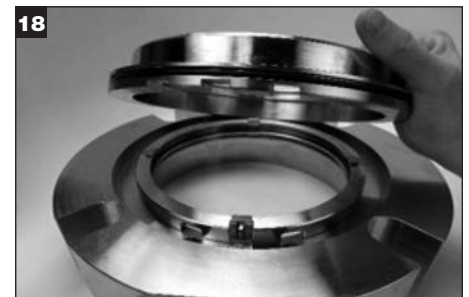
Fjern adapteren fra glanden. Fjern adapterens o-ring (Z) og avhend. Sett adapteren til side.
